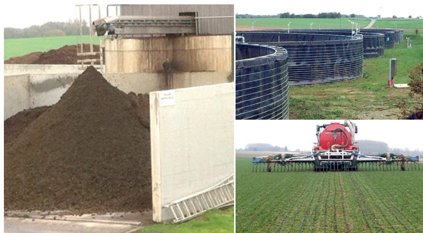
Le digestat est scindé en une fraction solide et une fraction liquide et épandue sur les champs par la coopérative.
